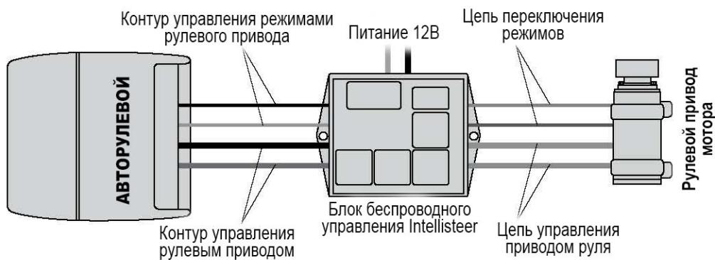
Подключение системы беспроводного управления Intellisteer к приводам типа S/T/R/H
